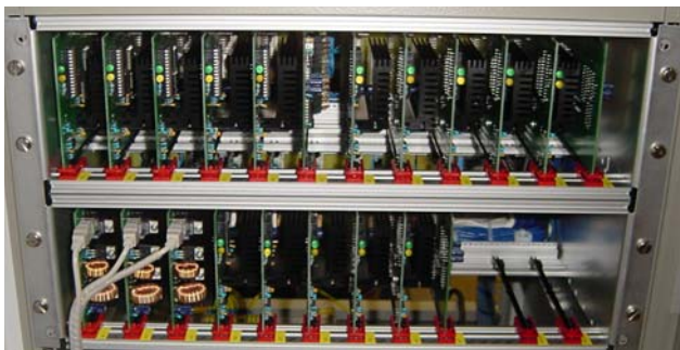
Beispiel: 3 Stationen je 5 Achsen über 3 unabhängige USB Kanäle angesteuert.
